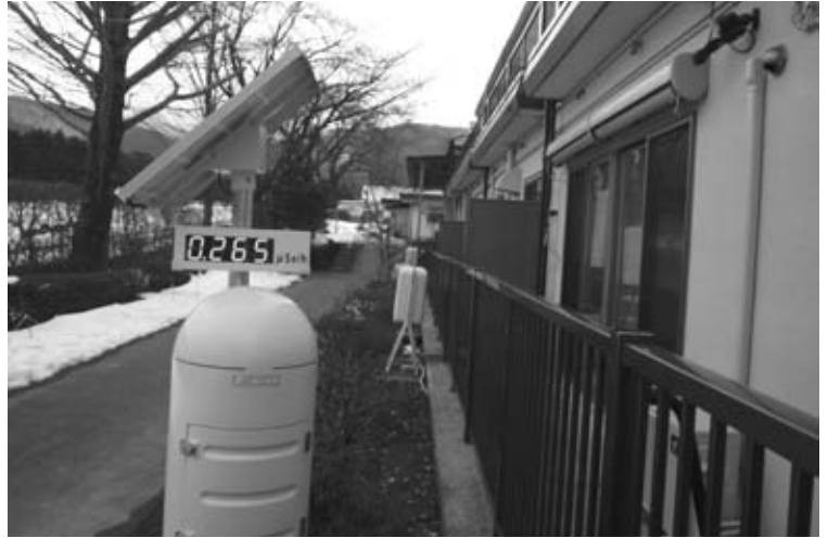
青葉学園に設置されたモニタリングポスト
